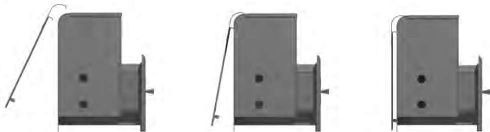
Рисунок - 9. Установка экрана-конвектора на печь.
