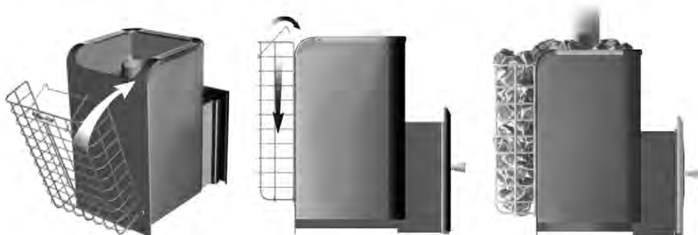
Рисунок - 10. Установка сетки-каменки на печь.
