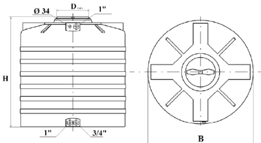
Для внутреннего слоя бака применяют полиэтилен без добавления красителей, в таком баке облегчен визуальный контроль качества и количества содержащейся в нем жидкости. Емкости серии ATV изготавливают методом ротационного формования. Емкости серии ATV-B, ATV-BW, ATV-DW, ETV-DW, ETV-BW про-изведенные методом экструзионного раздува, отличаются следующие особенности: уменьшенный вес и толщина стенки.
